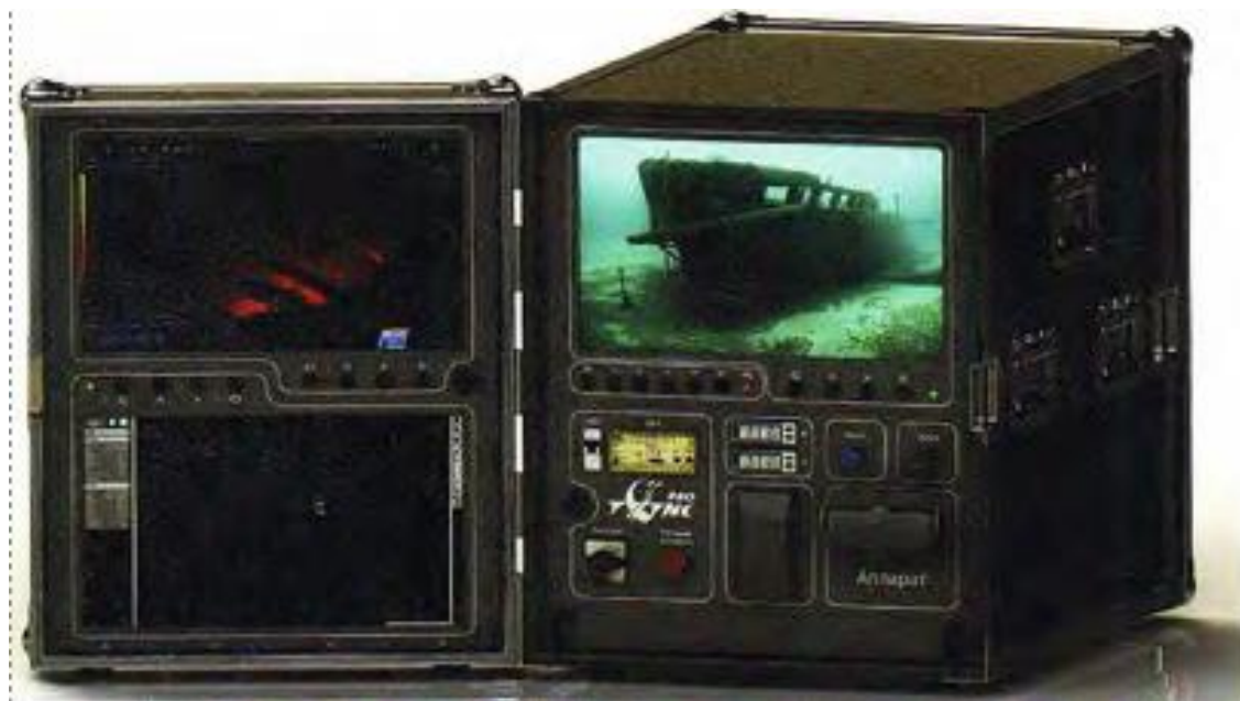
Рис. 2 Надводный блок управления (НБУ)
