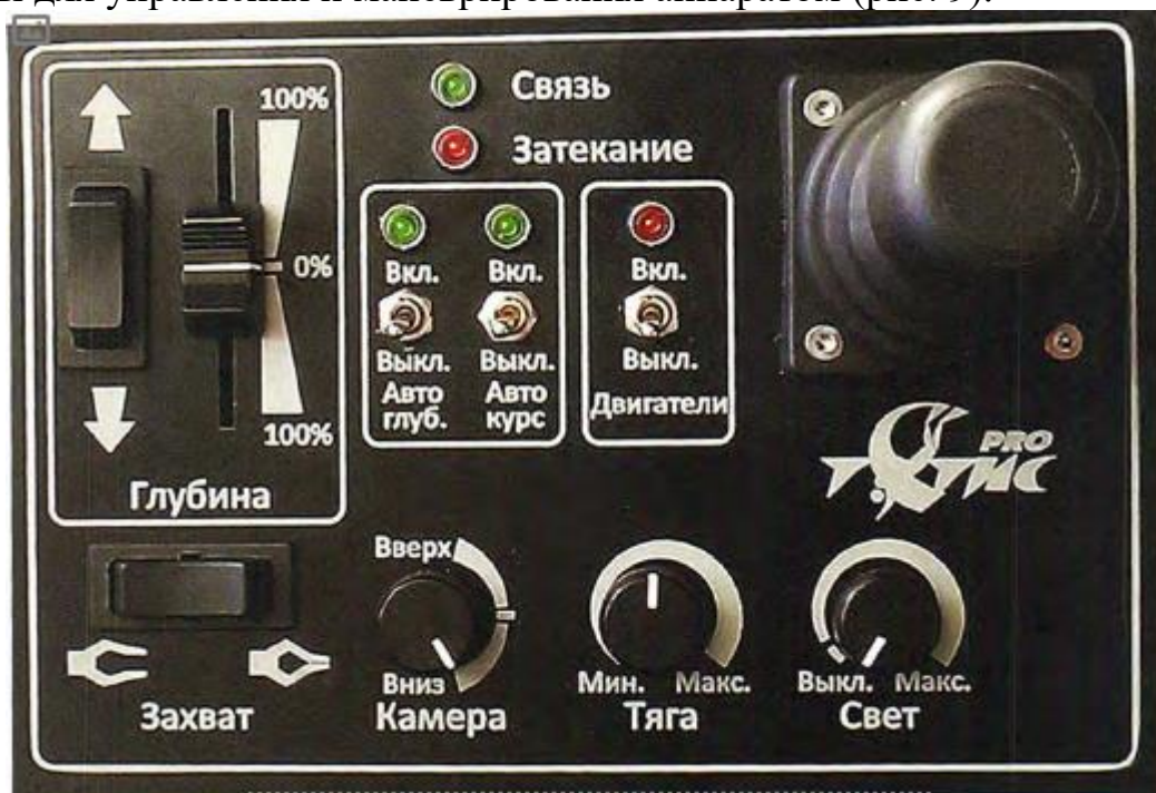
Рис. 9 Пульт ручного управления
