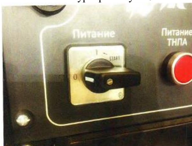
Рис. 25 Переключатель подачи питания на НБУ
