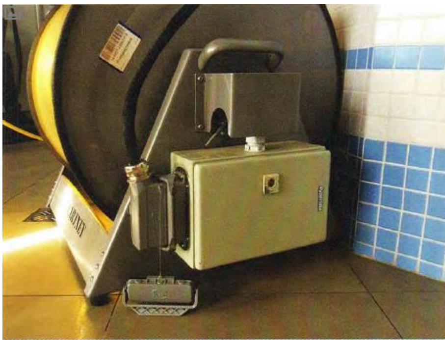
Рис. 12 Ручная кабельная лебедка
